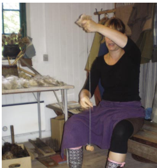
Εικόνα 15: Χειροποίητο γνέσιμο λιναριού από την Linda Mårtensson με χρήση αιωρούμενου πνιινόσχημου βαρυδιού.
